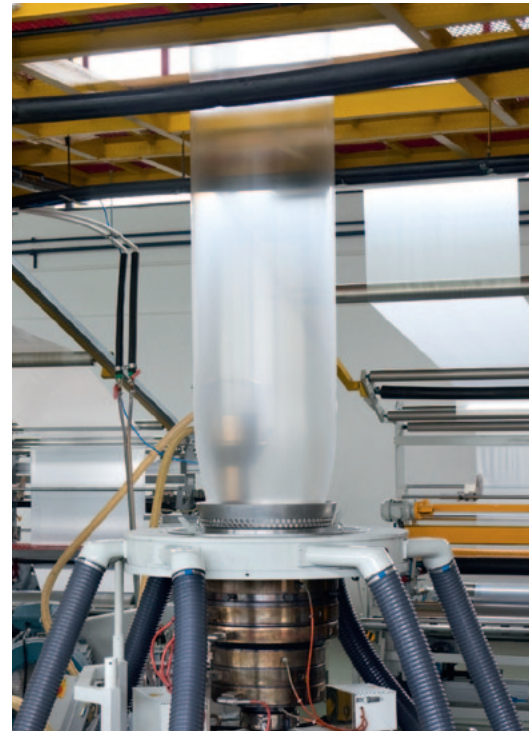
Bild oben: Extrusion von Polyethylen in einer Blasfolienanlage.
