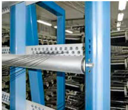
Bild: Texmer GmbH, Deutschland Umspul-Gatter in der Verarbeitung von Carbon Filamenten. Mögliches Einsatzgebiet für die TOPOCROM® carbon-processing Beschichtung bei Umlenkrollen, Ösen, Spulen.
